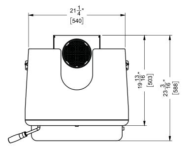
6" (152mm) Diameter OFFSET FLUE ADAPTOR
